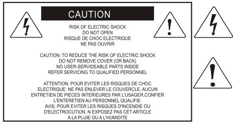
The lightning flash with arrowhead symbol within an equilateral triangle is intended to alert the user to the presence of uninsulated dangerous voltage within the product's enclosure, that may be of sufficient magnitude to electric shock to persons. Le symbole clair avec point de flèche à l'intérieur d'un triangle équilatéral est utilisé pour alerter l'utilisateur de la présence à l'intérieur du coffret de voltage dangereux non isolé d'amplieur suff
