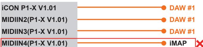
**Nota:** El puerto MIDI 4 es utilizado por el software iCON Pro Audio, iMAP<sup>TM</sup>, para cambiar los tres DAW que utiliza, para actualizar el firmware y para programar la pantalla táctil del panel 16 con las funciones de su elección.
