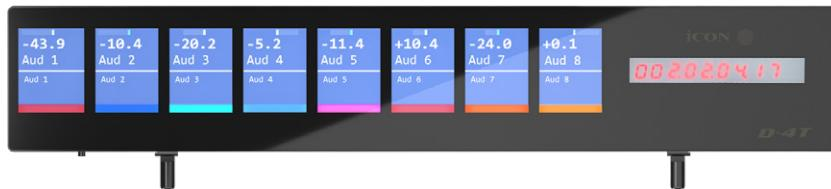
Las capacidades de visualización del P1-M se pueden ampliar con la unidad de visualización D-4T
