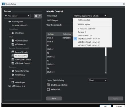
Come si può vedere, quando si configura il dispositivo come controller Mackie, è possibile scegliere tra 4 opzioni. Poiché abbiamo impostato Cubase in modo che risponda al pulsante di controllo DAW '2' del P1-M, selezioneremo 'MIDIIN2 (P1-M V1.02)'.
