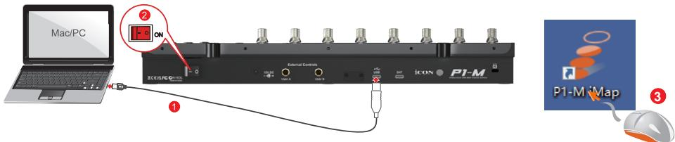
**Attenzione:** Il processo di caricamento del firmware DEVE essere completato e non interrotto durante il caricamento del file, altrimenti il firmware non può essere riscritto
